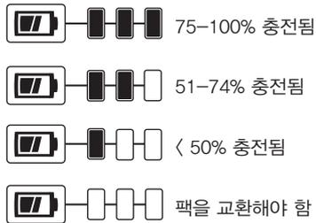
연료계를 작동시키려면, 잔량표시계 버튼 **13** 을 누릅니다. 녹색 LED 표시등 3개가 조합되어 켜짐으로써 충전 잔량 수준을 나타냅니다. 배터리 잔량이 사용 가능한 한계치 미만이면 배터리 잔량표시계가 켜지지 않으며 배터리를 재충전해야 합니다.
